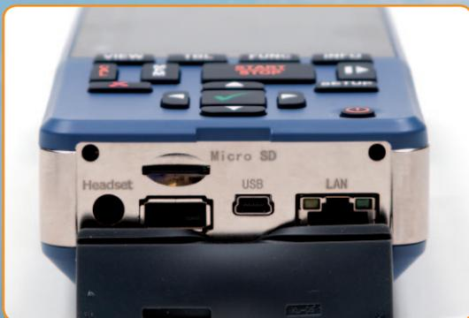
Eingebautes LAN, USB-Anschlüsse A und Mini-B, Micro SD-Karte und Headset-Anschluss für Sprachnotizen und zur Wiedergabe der Tonaufzeichnungen. WLAN und GPRS/3G-4G-Modems über USB.
