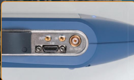
Auf der rechten Seite befinden sich: DC-Eingang, Ein- und Ausgang der Trigger für synchronisierte Abtastung durch mehrere Nor150 und der serienmäßige 15-polige I/O-Anschluss mit Hochgeschwindigkeits-Schnittstelle RS232, 3 digitalen Eingängen, 4 digitalen Ausgängen, Signalgenerator, AC-Ausgang, SPDIF, 3,3 VDC - 50 mA Stromausgang für Zusatzgeräte.
