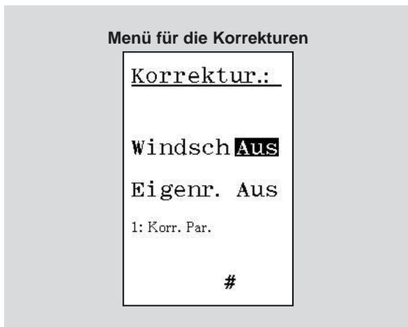
Die Windschirmkorrektur ist für den Windschirm Nor1451 optimiert. Die nominelle Korrektur ist in den Technischen Daten angegeben. Drücken Sie **SETUP > 1 > 4 > 2**, um das Menü für die Korrekturen aufzurufen. Navigieren Sie im Menü wie üblich (Pfeiltasten) und aktivieren oder deaktivieren Sie den Korrekturparameter „Windsch“ mit **INC** oder **DEC**.
