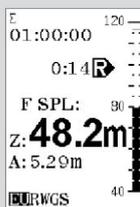
Die Anzeige als Engineering Units wird durch „EU“ in der linken unteren Ecke im Display gekennzeichnet.
