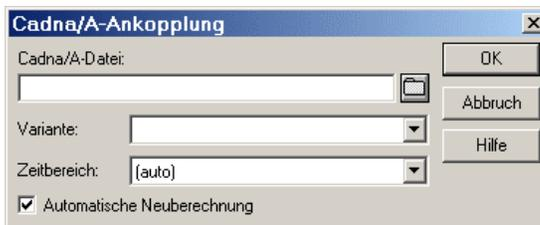
Die Optionen "Variante" und "Zeitbereich" ermöglichen gegebenenfalls vorhandene Varianten oder verschiedene Zeitbereiche (z.B. "Tag" oder "Nacht") auszuwählen. Bei Einstellung "(auto)" wird die in **CadnaA** aktuell eingestellte Variante als Eingangsdatensatz verwendet.
