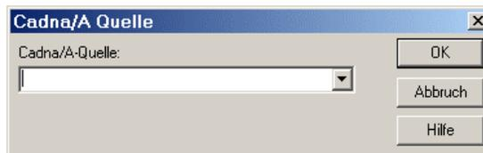
Wählen Sie aus dem Listenfeld den relevanten Immissionspunkt aus und klicken Sie anschließend OK. Der Schallpegel am gewählten Immissionspunkt wird als Schallquelle auf das Rechenblatt übernommen.
