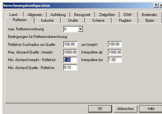
Falls der Fassadenpunktabstand kleiner ist als der Mindestabstand Immissionspunkt-Reflektor, wird für diesen Immissionspunkt keine Reflexion an der eigenen Hausfassade berechnet. Behalten Sie diese Einstellung zunächst bei.
