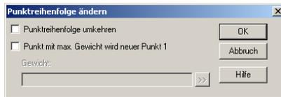
Die Option „Punktreihenfolge umkehren“ kehrt die Reihenfolge der Polygonpunkte in der Polygonpunktliste (Dialog **Geometrie**) um. Somit wird der aktuelle Anfangs- zum neuen Endpunkt und umgekehrt.
