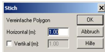
Dies spart Speicherplatz und erhöht die Rechengeschwindigkeit, weil alle Schnittberechnungen mit jedem durch zwei Punkte begrenztem Segment durchgeführt werden müssen. Insbesondere bei importierten Dateien sind Höhenlinien und auch Verkehrswege (Straßen, Schienen) oft unnötig detailliert. Hier kann durch Anwenden des Befehls **Stich** eine erhebliche, die Genauigkeit nicht beeinträchtigende Datenreduktion erreicht werden.
