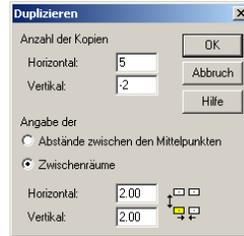
Tragen Sie die Anzahl der gewünschten Kopien (horizontal/vertikal) ein. Bei negativen Eingaben werden die Duplikate in negativer Koordinatenrichtung erzeugt.
