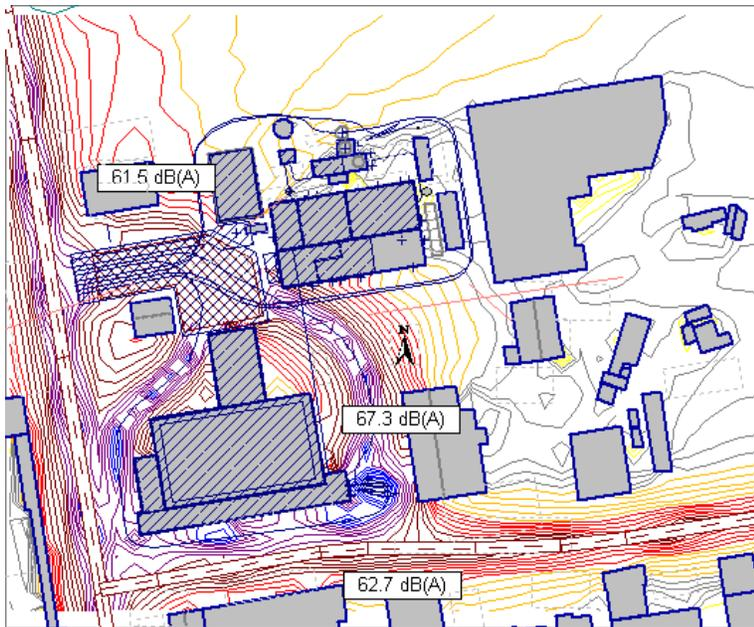
Pegelraster innerhalb einer Kraftwerksanlage
