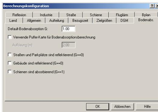
Registerkarte „Bodenabsorption“: Eingabe der Default-Bodenabsorption
