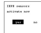
Bei „ja“ werden für alle betreffenden Kanäle die IEPE-Stromquellen sofort zugeschaltet und bleiben aktiv, bis entweder ein anderer Sensortyp gewählt oder der Nor136 ausgeschaltet wird. Bei „nein“ werden die betreffenden Stromquellen erst zugeschaltet, wenn **START** oder **TEST** betätigt wird. Wenn die so gestartete Messung beendet wird bleiben die betreffenden Stromquellen aktiv, bis entweder ein anderer Sensortyp gewählt oder der Nor136 ausgeschaltet wird.
