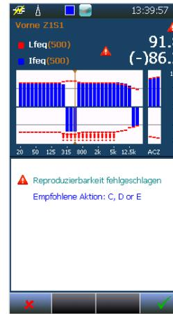
Abbildung 19.55 - Das Fenster mit den Warnungen zeigt Warnungen für die Cursorposition. Drücken Sie auf den Aktionstext, um eine Erklärung anzuzeigen.
