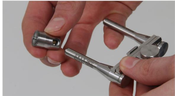
Abbildung 19.2 - Montage des Mikrofons und Adapters auf dem Vorverstärker
