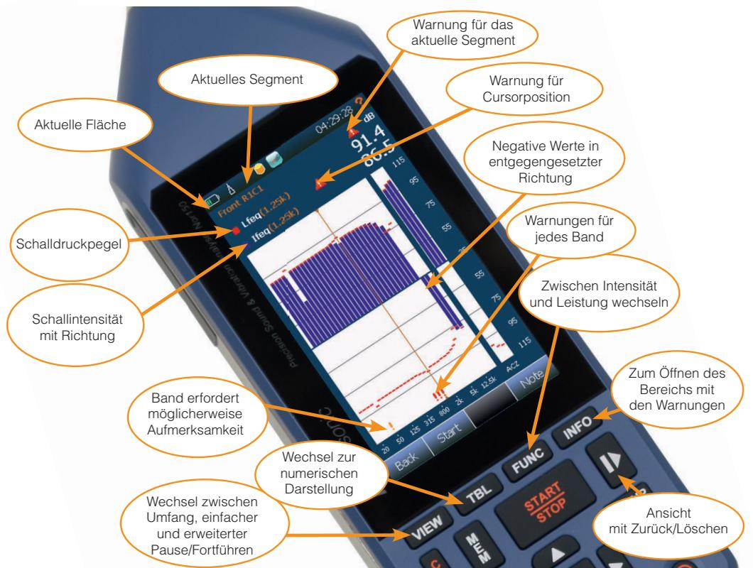
Abbildung 19.41 - Überblick über die einfache Ansicht im Schallintensitätsmodus
