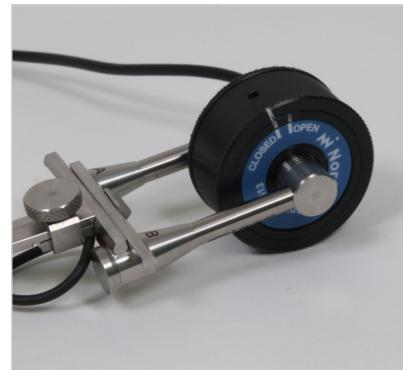
Abbildung 19.21 - Abstandsregler und Stellknopf festziehen, Nor1294 schließen
