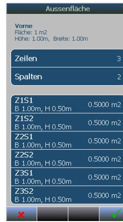
Abbildung 19.37 - Eigenschaften und Segmente, die zur Vorderseite der Fläche gehören. Das Ändern der Zeilen oder Spalten führt zum Datenverlust.
