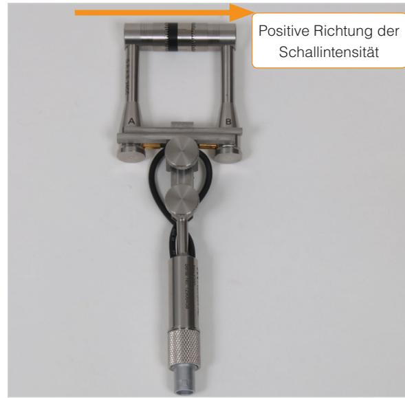
Abbildung 19.4 - Zusammengebaute Nor1290-Sonde mit 12-mm-Abstandshalter - positive Richtung von A nach B.
