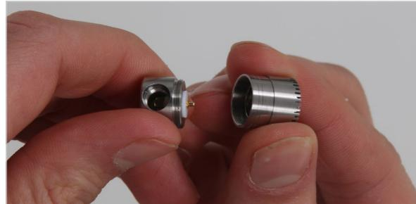
Abbildung 19.1 - Montage des Mikrofons auf dem Winkeladapter
