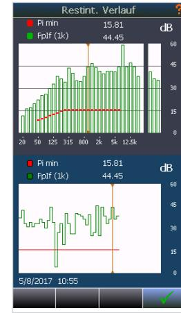
Abbildung 19.25 - Ein ausführlicher Verlauf steht für das Restfeldspektrum zur Verfügung
