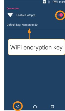
Abbildung 19.12 - Hotspot aktivieren, Verschlüsselungscode notieren und mit Zurück-Schaltfläche akzeptieren
