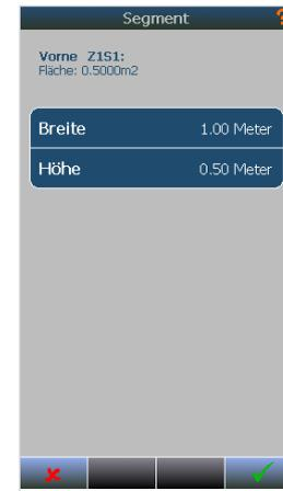
Abbildung 19.38 - Eigenschaften für ein einzelnes Segment. Das Ändern der Parameter an einem Segment führt nicht zum Datenverlust.
