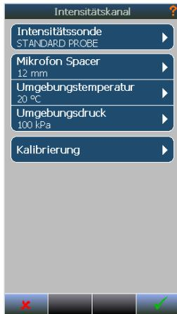
Abbildung 19.30 - Verwendung des Kanalmenüs, um die Umgebungsparameter einzurichten
