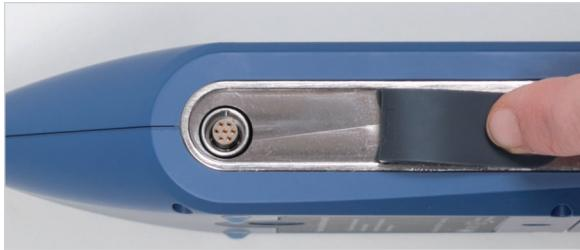
Rechts am Gerät befinden sich unterschiedliche Kommunikationsbuchsen und der Stromanschluss. Das Netzgerät Nor345A wird an die große, runde Buchse angeschlossen. Siehe *„Netzgerät Nor345A“ Seite 170* für eine ausführlichere Beschreibung.
