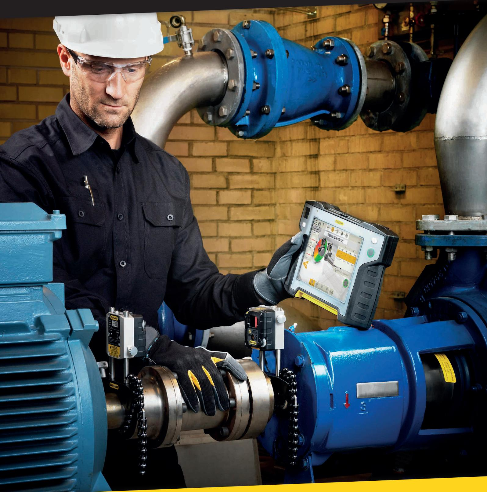
Ausrichtungssystem für alle wichtigen Schritte der Maschineninstallation.
